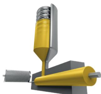
La technologie Smart Yarn consiste à gainer de polymère des fils polyester haute ténacité qui seront ensuite tissés puis stabilisés pour obtenir des produits avec d'excellentes propriétés de résistance mécanique et de tenue aux UV.
